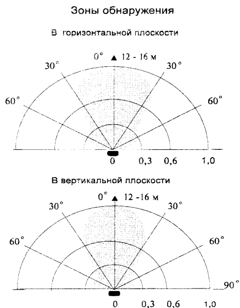
Рисунок 3 - Вариант блокировки объема помещения радиоволновым извещателем. (Размещение и схема подключения извещателя)
